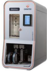
Viscosímetro totalmente Automático para Muestras Altamente Viscosas
